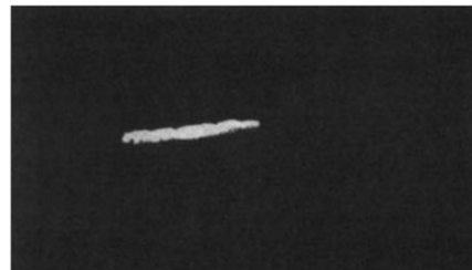
obr.2: stopa \alpha částice z kosmického záření
