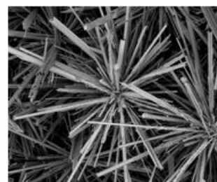
Krystalizace reflektoru při autonehodě
