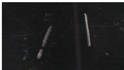
Obr. 2 Stopy alfa částic
