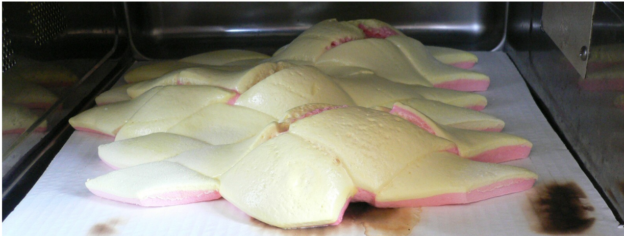
Obrázek 1: Demonstrace výskytu stojatých vln v mikrovlnce
