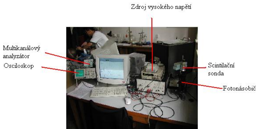
Obr. 1 Experimentální aparatura pro měření spekter záření gama
