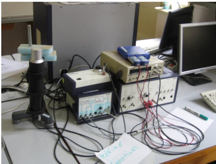
Námi používaná aparatura (zleva scincilátor s fotonásobičem, multikanálový analyzátor a počítač na vyhodnocení)
