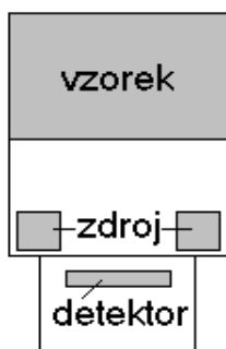
Obr. 1: Schéma XRF analyzátoru
