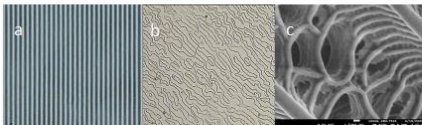
Obr. 1: Difraktivní struktury: a) harmonická difrakční mřížka a b) hologram v optickém mikroskopu a c) detail motýlího křídla v elektronovém mikroskopu.
