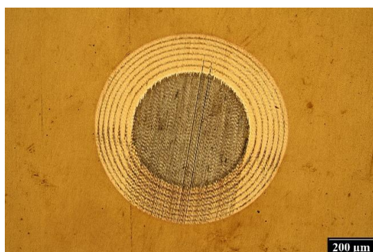
Obr. 3 – Vybroušená dutina v multivrstvě TiN/Ti.
