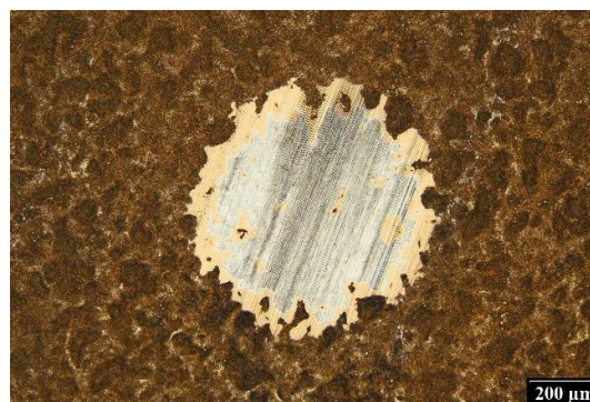
Obr. 4 – Vybroušená dutina v průmyslově vyrobené vrstvě TiN.
