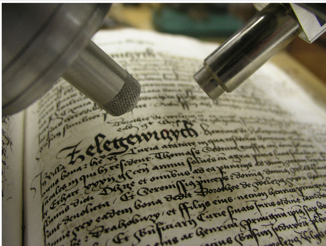
Obrázek 2: Rentgenka (vlevo) a polovodičový detektor (vpravo) při měření desek zemských ze sbírek Státního archivu v Praze
