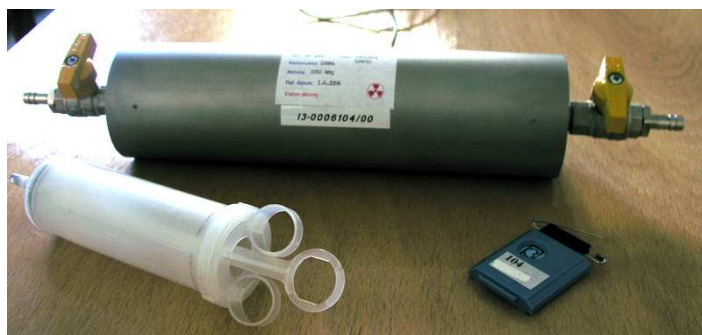
Průtokový zdroj radonu a žaneta
