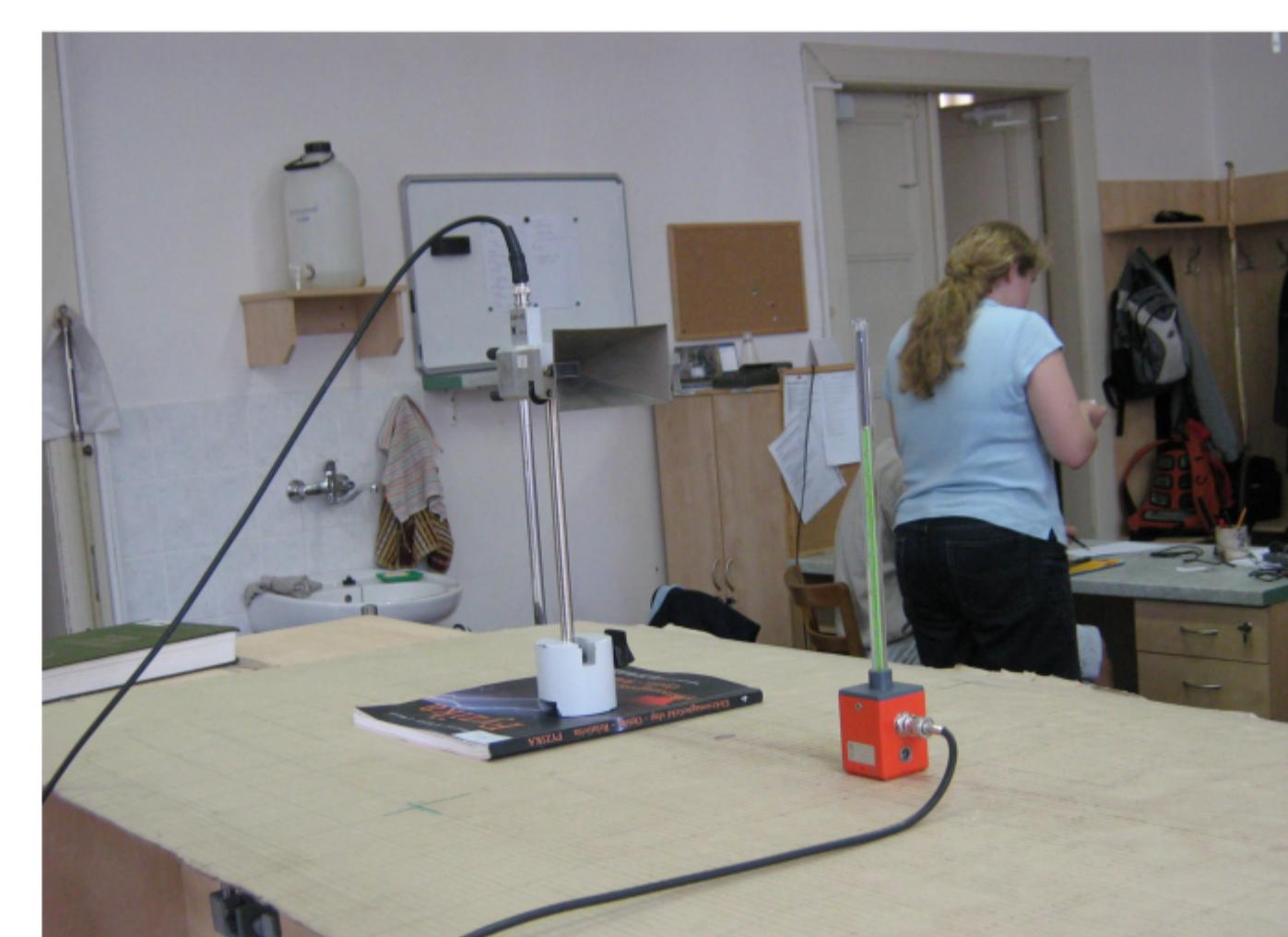
Intenzita elektromagnetického vlnění závisí na vzdálenosti od zdroje. Čím je tato vzdálenost větší, tím je intenzita elektromagnetického pole menší. Všimněte si také velké směrovnosti Gunnova oscilátoru.
