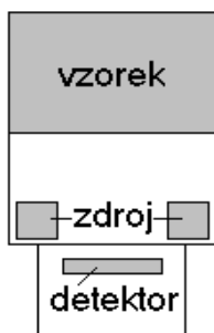
Obr. 1: Schéma XRF analyzátoru
