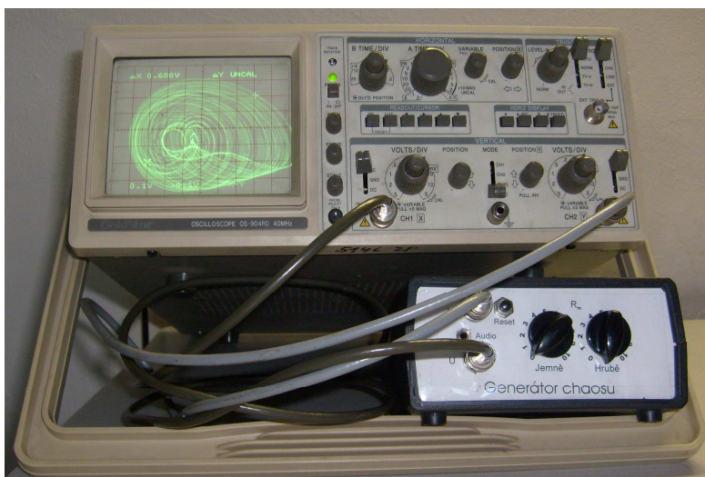
Obrázek 4. (nahore, generátor chaosu napojený na osciloskop) a 5. (vpravo, kyvadlo)
