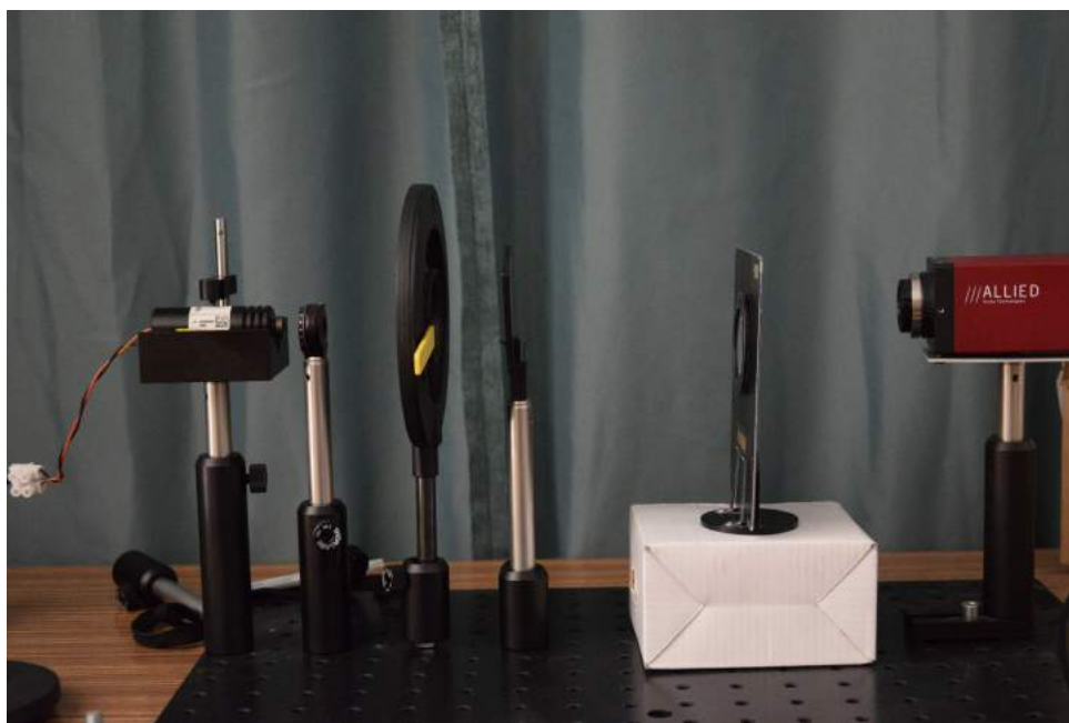
Obrázek 1: Použitá aparatura na zachycení difrakčního obrazce. Komponenty zleva: laser, dvojice polarizačních filtrů pro snížení světelné intenzity laseru, štěrba, konvexní čočka s ohniskovou vzdáleností +100mm, fotonový CCD detektor.
