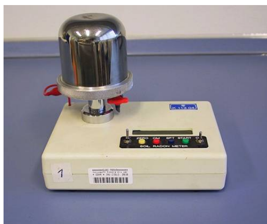
Obrázek 2: Měřicí systém ERM-3 používaný k měření objemové aktivity radonu [5].
