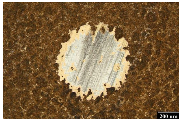
Obr. 4 – Vybroušená dutina v průmyslově vyrobené vrstvě TiN.
