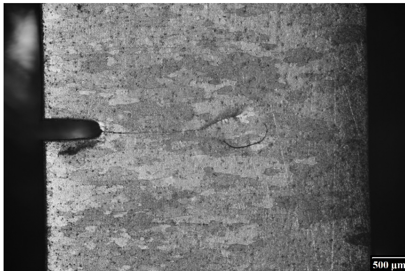
Obr. 1: Trhlina ve vzorku šíří se z vrubu
