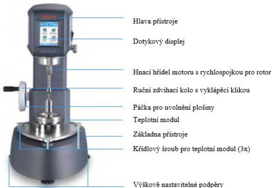
Obr. 2 Rotační ponorný viskozimetr Haake Viscotester iQ Thermo Fisher s válcovou geometrií (CC25 DIN/Ti) [4]
