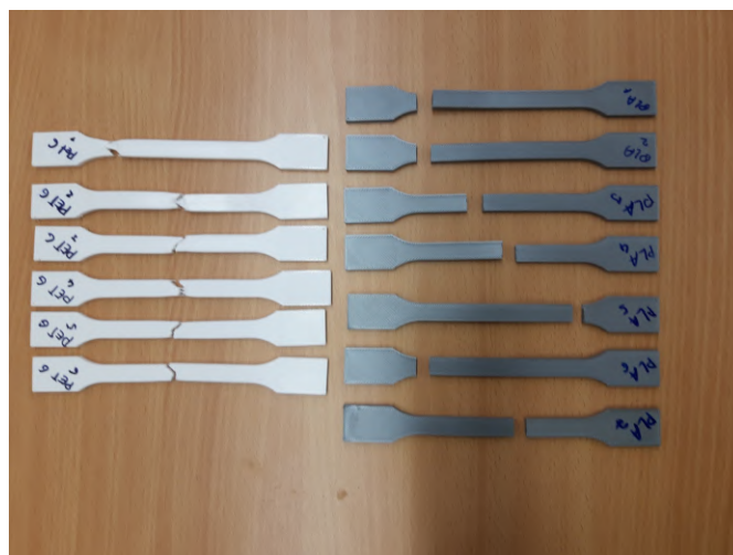
Obrázek 2: 13 zkušebních těles, 7 PLA, 6 PETG po tahové zkoušce
