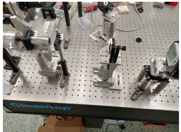
Obrázek 3: postavený difraktor (1 - neonová lampa, 2 - mikroskop, 3 - slitka, 4 - čočka, 5 - difrakční deska, 6 - kamera)
