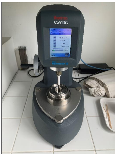
Obrázek 1 Rotační ponorný viskozimetr Haake Viscotester iQ Thermo Fisher s válcovou geometrií (CC25 DIN/Ti)
