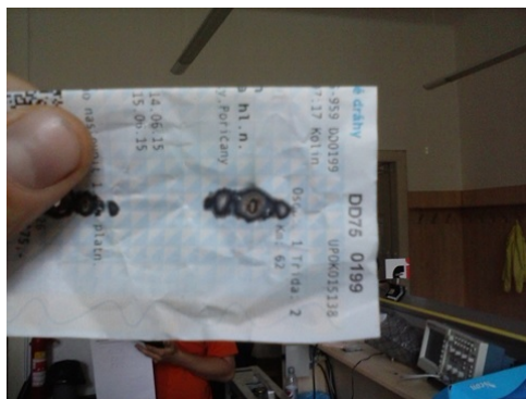
Obrázek 2: stopy po laseru na thermopapíru
