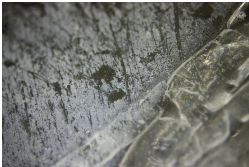
Obrázek 4 - praskliny ve skleněném vzorku a usazeniny vypařeného skla na povrchu
