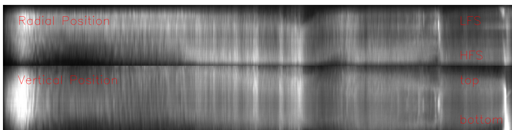
Obrázek 3: Záznam z rychlých kamer ukazující časový vývoj polohy plazmatu. Z průběhu je patrný pozitivní vliv stabilizace na délku výboje.
