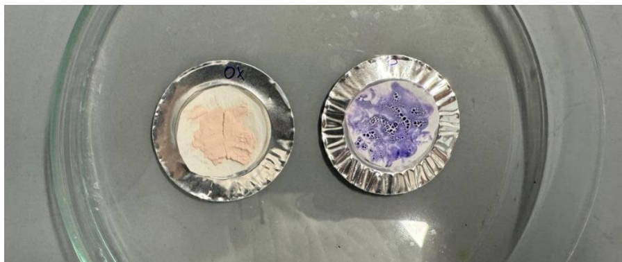
Obr. 3: Vlevo sraženina z roztoku s kyselinou šťavelovou. Vpravo sraženina z roztoku s fosfátovým pufrům.
