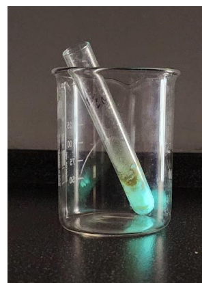
fluorescin s kyselinou boritou v podobě skelné směsi několik sekund po ozařování UV světlem
