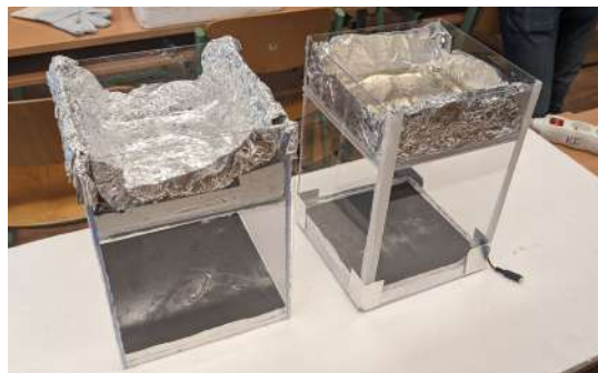
Obrázek 2: Dvě komory, chlazené chladícím gelem
