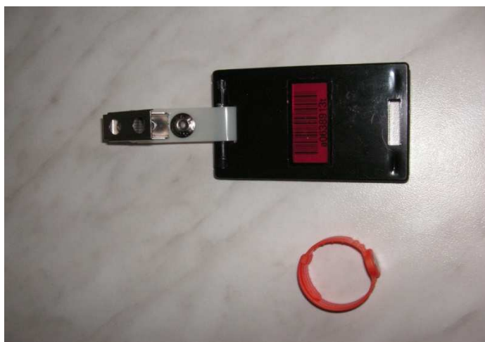
Osobní dozimetr pro zachycení záření, kterému je nositel vystaven
