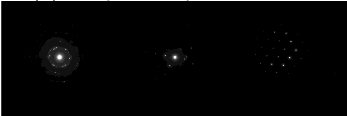
Obr. 6: difrakce Al-Mn-Zr při využití velké, střední a malé clony
