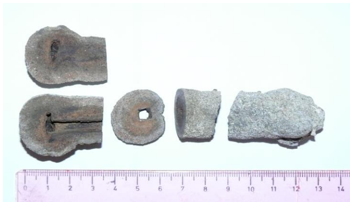
Obrázek 4: Rozřezaný antický hřeb
