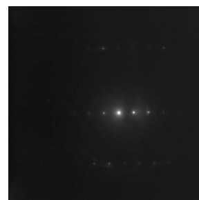
difrakční obrazec jednoho zrna ve slitině Al-Mn
