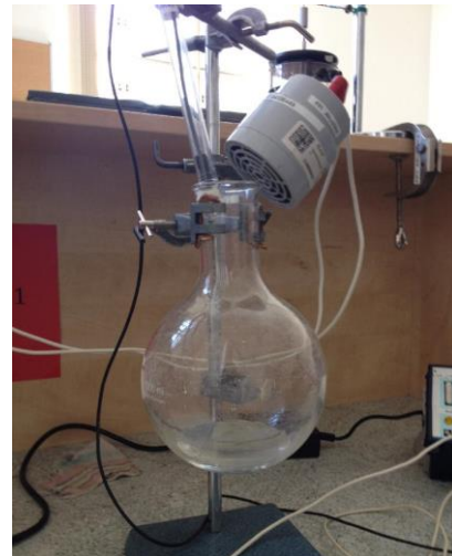
Obr. 2: Baňka použitá jako Helmholtzův rezonátor
