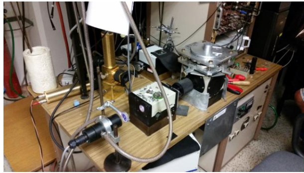
Obrázek 3 - Fotografie vybavení pro měření excitačního a emisního spektra
