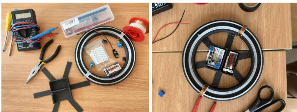
Obrázek 5: Model kruhového urychlovače, synchrotronu. Vlevo před stavbou, vpravo hotový funkční model.
